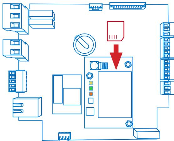
Si los tres LED no están encendidos después de insertar la tarjeta SIM, compruebe la configuración del módem.
