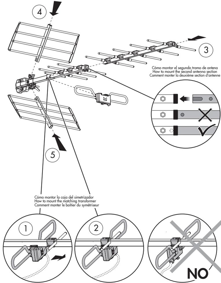
MONTAJE DE LA POLARIDAD HORIZONTAL O VERTICAL
