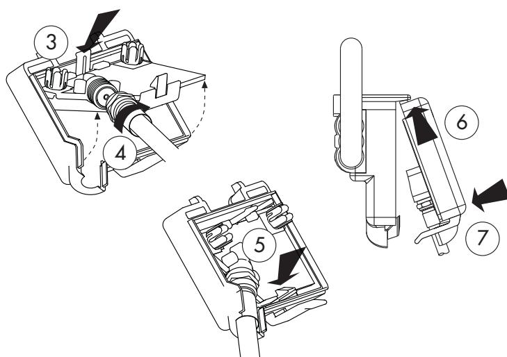
MONTAJE DE LA POLARIDAD HORIZONTAL O VERTICAL
