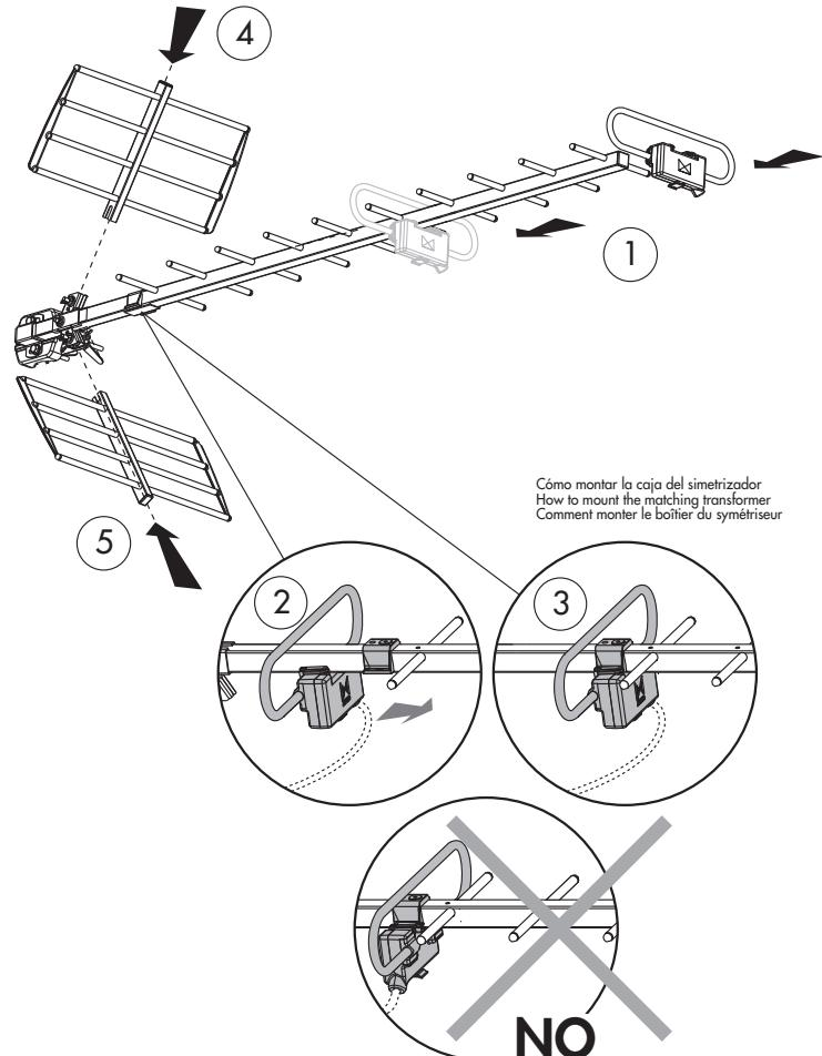
CÓMO CONECTAR EL CABLE COAXIAL EN LA CAJA DEL SIMETRIZADOR
