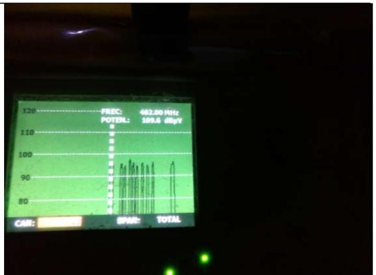
La señal que observamos es a la salida de la central programable hacia las viviendas. Independientemente de la señal recibida por la antena, la central programable iguala las señales, con lo que hay un nivel medio a la salida en todos los canales entorno a 95dB. Las imágenes pertenecen a diferentes comunidades de propietarios.
