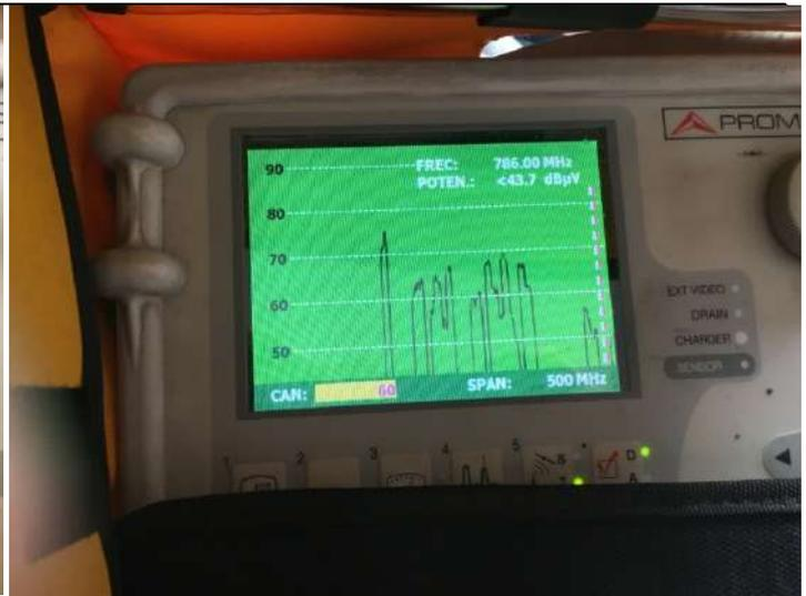
El canal 22 sale de la central con 75dB y el canal 58 con 55dB. La antena capta mejor los canales bajos y la central de banda ancha solo se limita a amplificar la señal recibida. Medido en la salida de Test.
