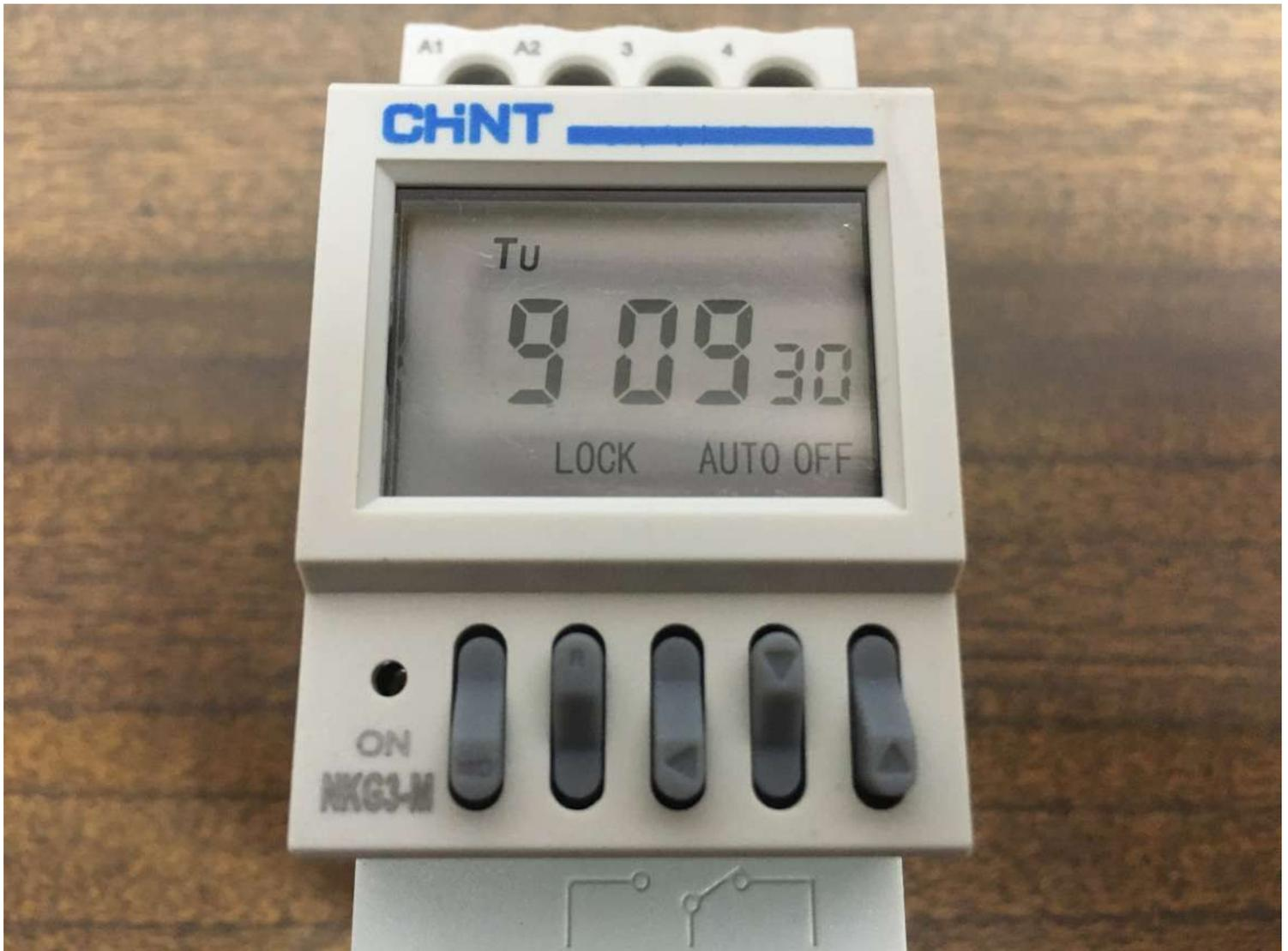
El temporizador se mantiene en estado bloqueado “LOCK”, mientras no lo estamos usando. Cuando le llega energía la luz encima de ON se mantiene encendida.
